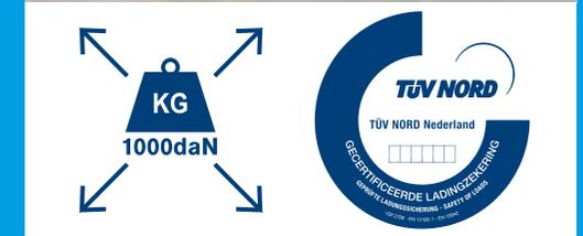
Tutti i rimorchi Hapert sono dotati di sistema di fissaggio carico certificato TÜV. Ogni punto di fissaggio ha una portata di 1000 kg.
