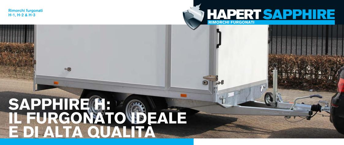
Grazie al telaio in acciaio saldato e zincato a caldo e alla sovrastruttura incredibilmente robusta, i modelli Sapphire H sono perfettamente adatti per trasportare senza problemi il vostro prezioso carico.
