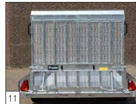
**Standard:** rampa unica posteriore h.cm.150 con chiusure rinforzate di serie.
