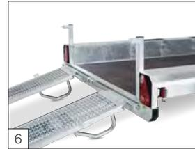
**Optional:** coppia rampe in acciaio zincate l. 1500 mm al posto della rampa unica posteriore.
